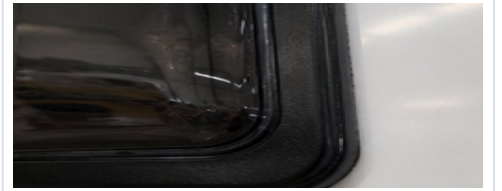
B05 - Pencere, kapı ve servis kapağı fitil/contaları
