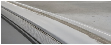
B04 - Tavan kaplaması, mastik ve panel ekleri
